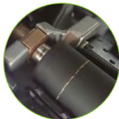
Bei Verschleiß der Druckplattenwalze beginnt die weiße Linie zu verbleichen.
